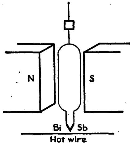
FIG. 113.—Duddell thermogalvanometer
